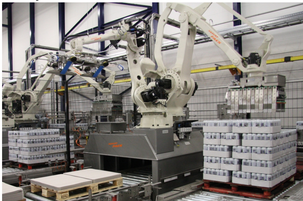
Robertpack: Moderne Verpackungsanlage für die Getränkeindustrie mit einer Ausbringung von 100.000 Bierdosen stündlich.
